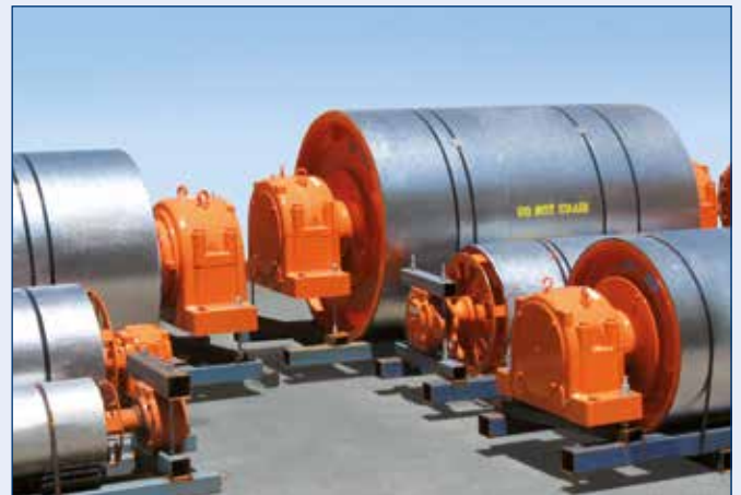
Versandbereite Bandtrommeln mit Spannsätzen Ready-for-shipping belt drum with Locking Assemblies
