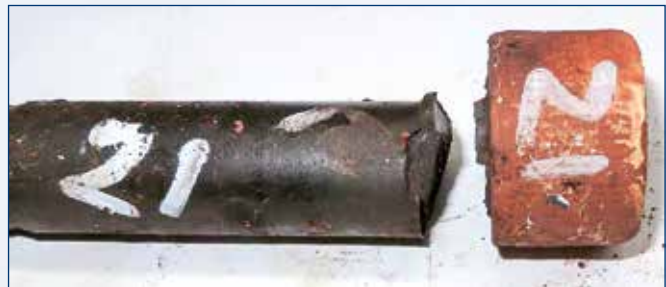
Schraubenbruch · Bolt failure
